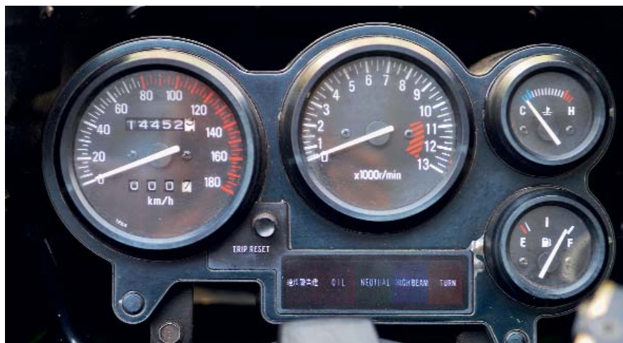
Mindentudó: a műszerfal mutatja az üzemanyagszintet és a vízhőmérsékletet, nyolcvan felett a japán szabályoknak megfelelően kigyullad egy vörös jelzőfény
